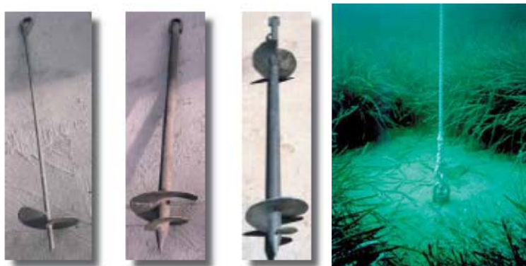
Εικόνα 12. Κοχλιοειδής άγκυρα και εκτεθειμένο τμήμα (Francour et al., 2007)
